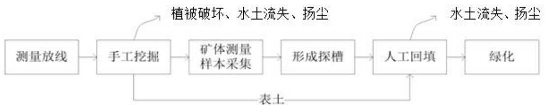
图 2-2 槽探施工流程及产污环节示意图
