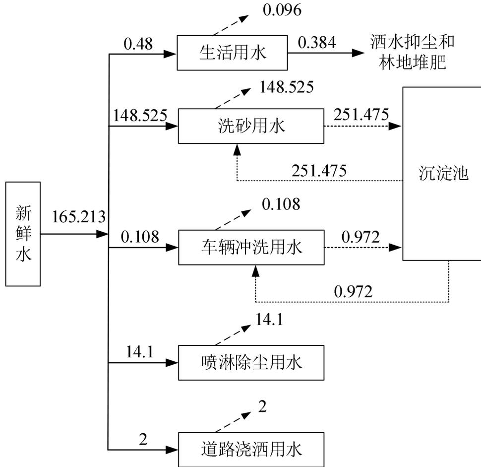
图2 本项目水平衡图 (单位: m<sup>3</sup>/d)
